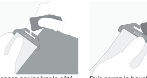
Puis serrez la boucle sur le côté le plus court du crochet. Répètez le processus pour les autres raccords.
