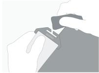
Lorsque la bande textile glisse hors du crochet, tirez dessus. Répètez l'opération pour les autres raccords.
