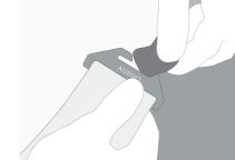
Retirez l'EES en tirant la bande textile d'un côté du crochet métallique.
