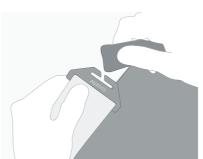
Commencez par insérer le côté le plus long du crochet EES dans la boucle de la sangle de connexion supérieure.
