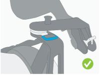
Vérifiez que la connexion entre la structure dorsale et le gilet est bien fixée par la boucle.
