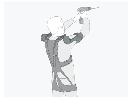
Il OmniSuit supporta il lavoro al di sopra del livello delle spalle, come la manipolazione di un utensile elettrico, quando indossa i polsini d e l modulo di supporto per le spalle.
