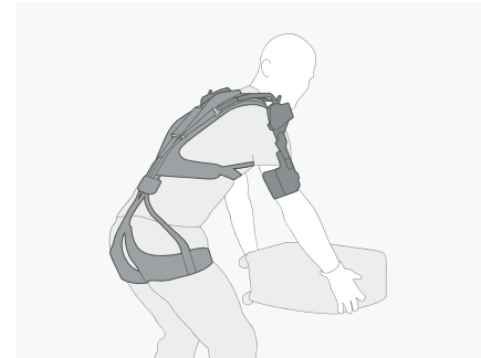
L'OmniSuit soutient le travail dans des positions penchées vers l'avant et le soulèvement de charges sous le niveau des hanches lorsque le module de soutien dorsal est activé.
