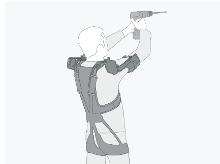
L'OmniSuit soutient le travail au-dessus des épaules, tel que la manipulation d'un outil électrique, en portant les brassards du module de soutien d'épaule.
